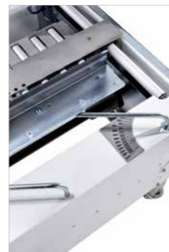
▲ REGOLAZIONE LARGHEZZA SCATOLA ADJUSTMENT BOX WIDTH
