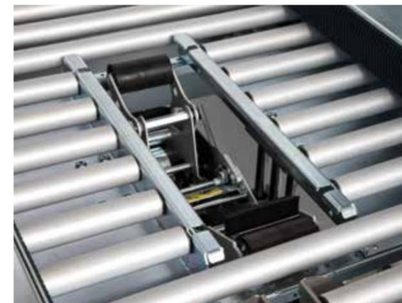
◀ Sistema di esclusione della testa nastrante inferiore.
