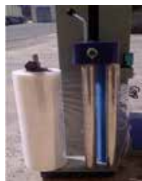
Carro de estiro film con ajuste de la tensión.
