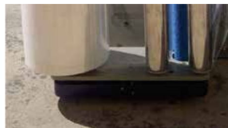
Sensor de seguridad para detección de obstáculos en el descenso del carro porta-bobinas.
