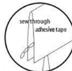
Aplicación de una abrazadera de papel adhesivo en el cosido Aplicação de um suporte de papel adesivo na costura
